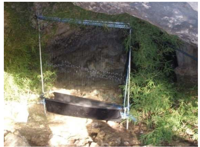
ภาพที่ 2 อุปกรณ์ดักจับค้างคาวแบบกับดักสลิงซึ่งแนวตั้ง หรือ Harp Trap
